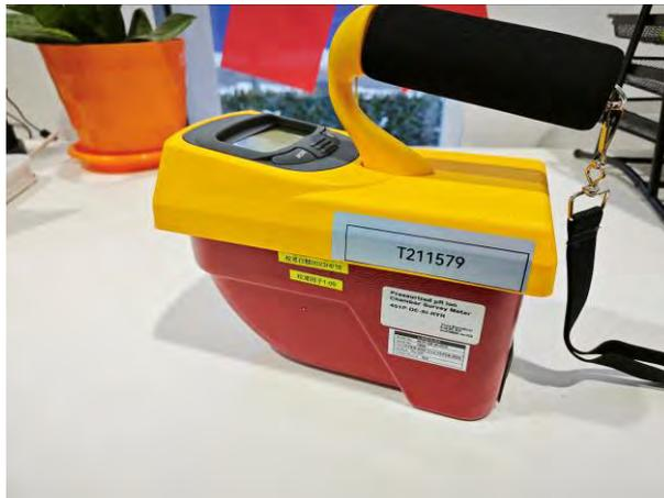
已购置的瑞典产 451P 型剂量率仪
